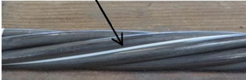
Optische vezel met GFRP coating Diameter 1 mm
