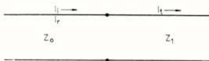
Fig.2. Relaties op grensvlak van twee transmissielijnen.
