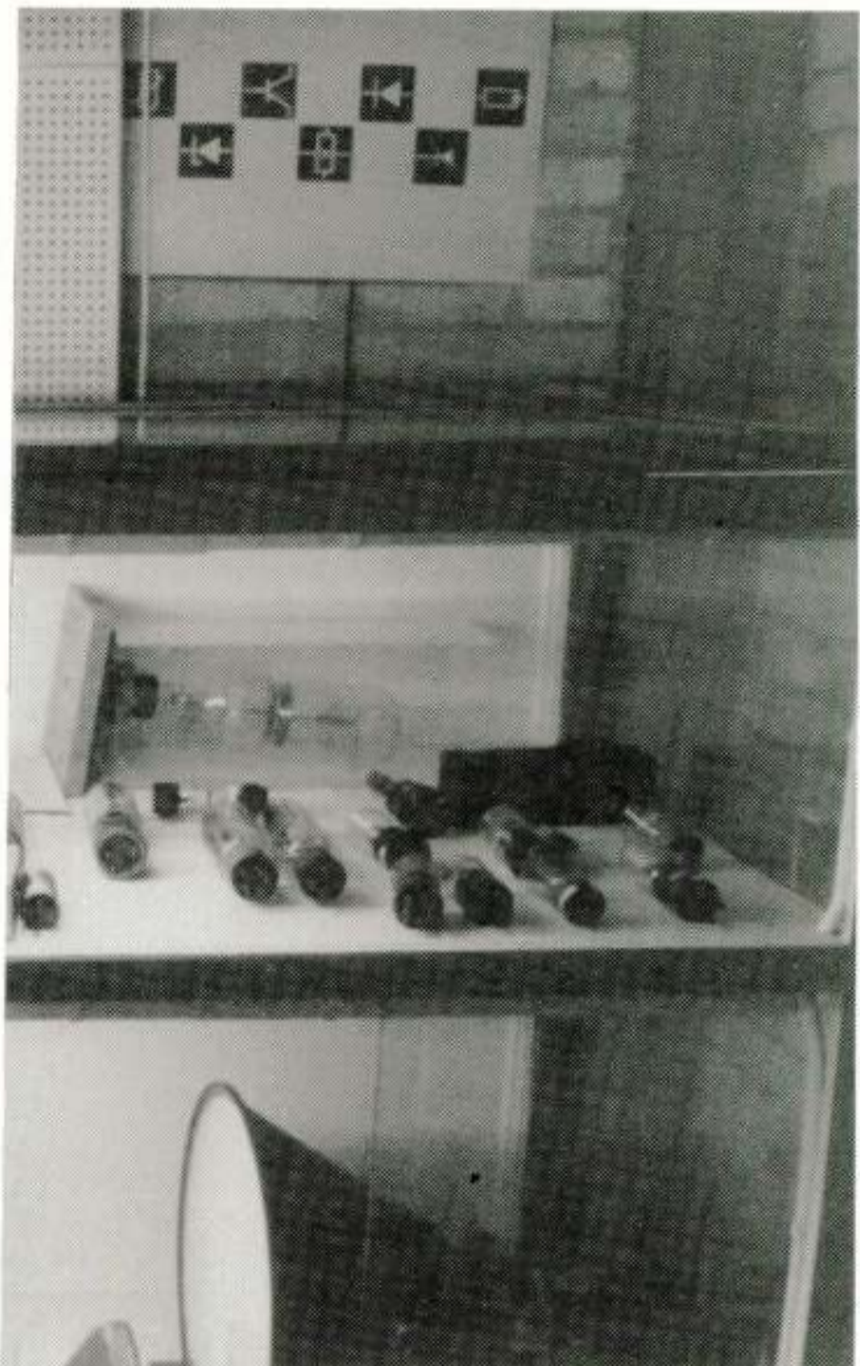
Enkele van de eerste radiolampen, later buizen genoemd. Rechts een van de eerste, nog zonder "getter". In het midden, ook zeer oude typen met een afsmeltpuntje bovenop. En links van boven naar beneden steeds nieuwere typen: topaansluitingen, afschermingslakken, zijcontacten, sleutelbuizen, metalen buizen, harde pennen, zachte pennen, etc.
