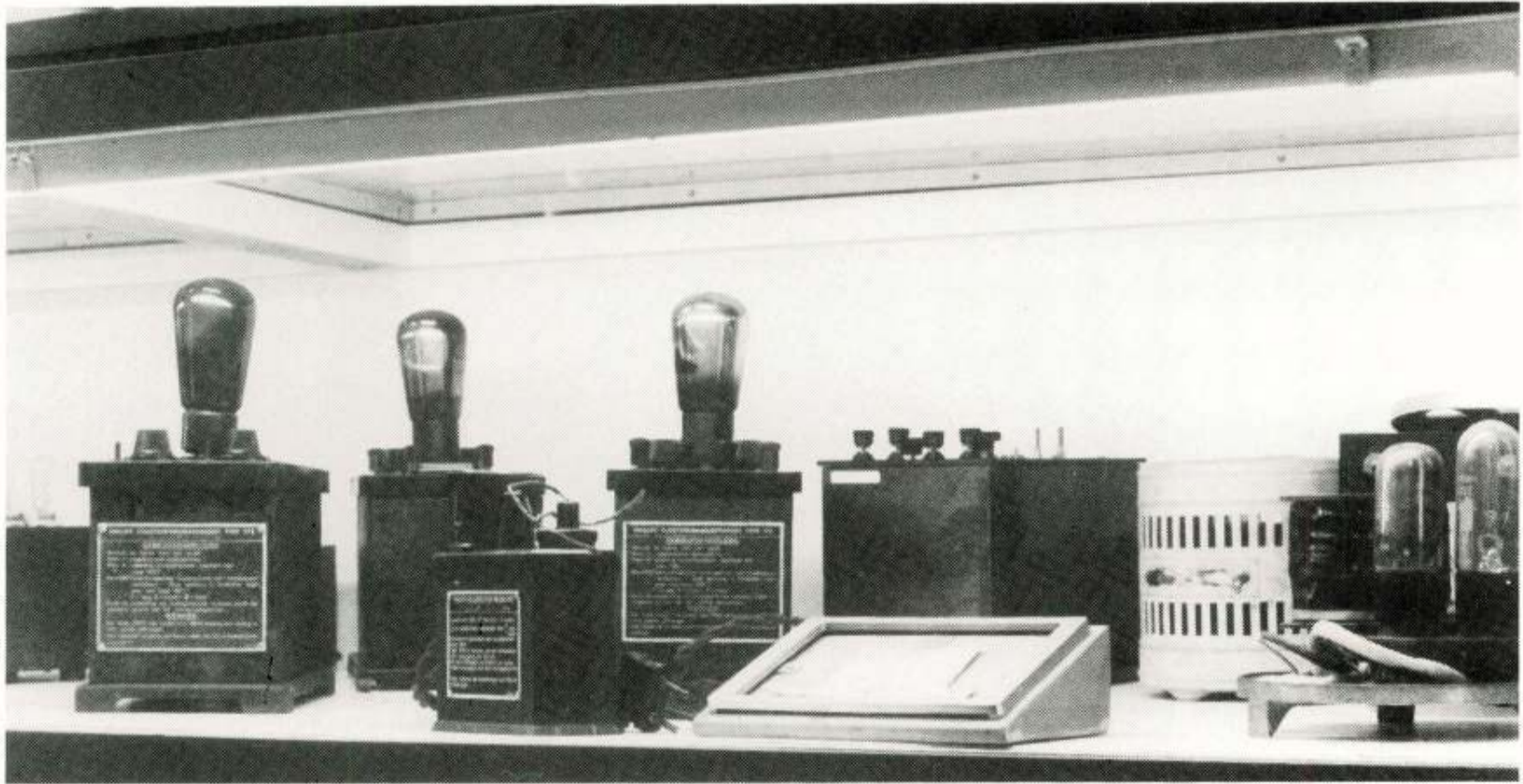
Links drie "plaatstroomapparaten" met de gelijkrichter 373 er bovenop. Daarvoor een "druppellader" voor accu's en rechts de alom gebruikte acculaders voor 4 Volt met kwikdampgelijkrichter en weerstandlamp.
