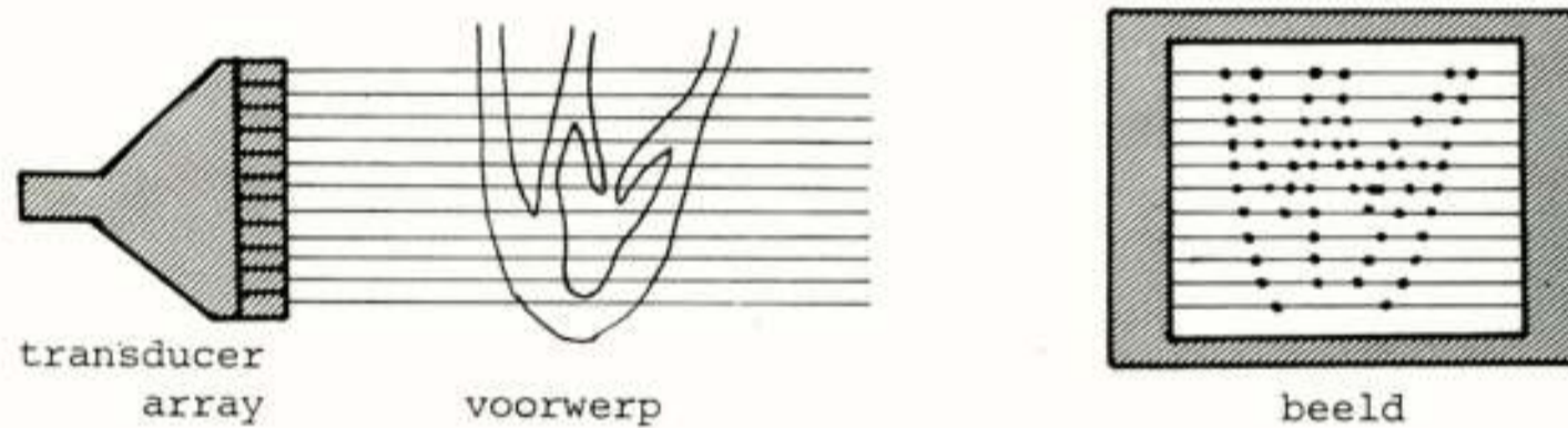
Fig. 4. Het principe van de lineaire scan.
