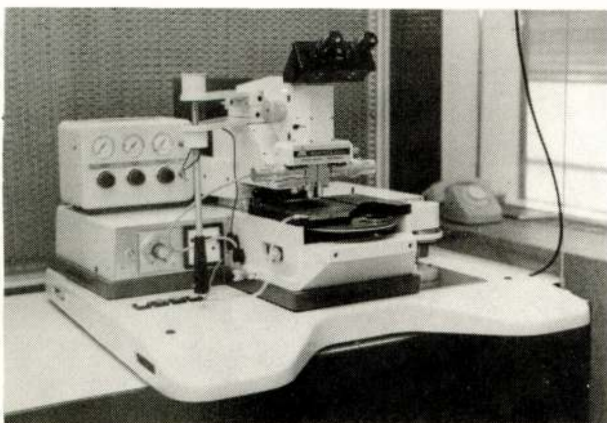
Fig. 2. Uitricht- en belichtapparaat voor het belichten van met fotolak bedekte siliciumplakken.
