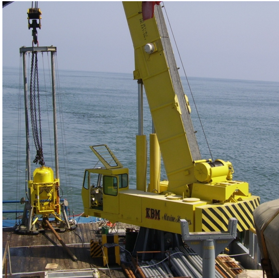
Monstername met de 'triflip': door TNO ontwikkelde hydraulische vibrocorer.
