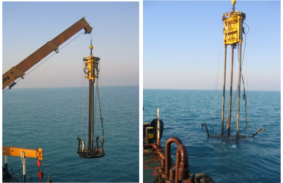
Vibrocorer voor de bemonstering van zandbodems.
