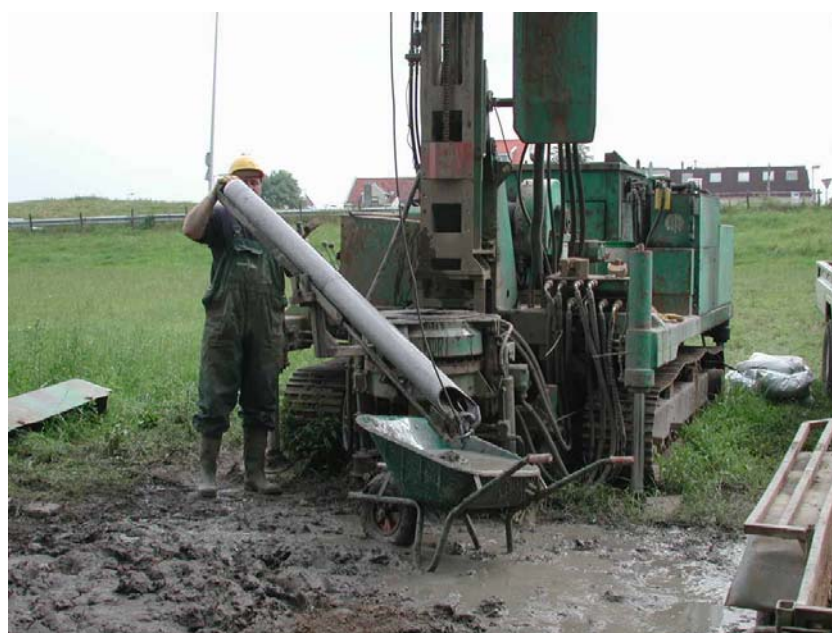
Onderzoek stabiliteit van de Bovendijk in IJsselmonde door het nemen van ongeroerde grondmonsters.
