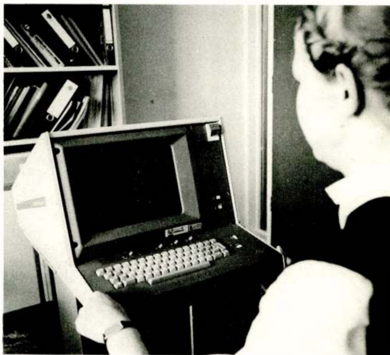
Fig. 9. Station voor interactieve manipulatie van een polycell layout. (Tektronix 4012)
