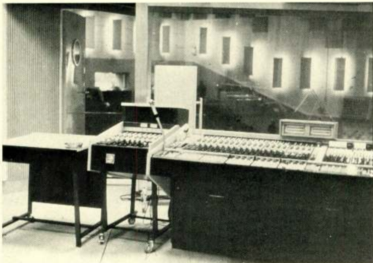
Fig. 6. Moderne regeltafel voor stereofonie. De module-opbouw biedt per kanaal de mogelijkheid om alle gewenste monofone en stereofone effecten te bereiken.
