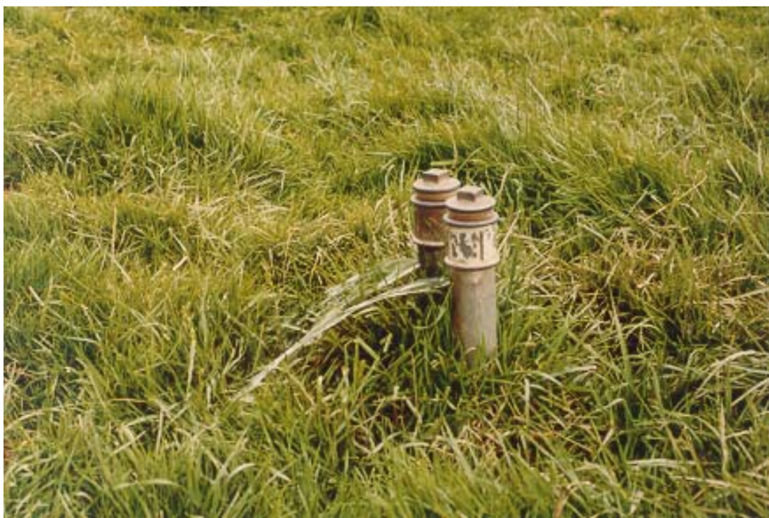
Foto b5.29 Overlopende peilbuizen achter de Lekdijk tijdens hoog water voor de dijk (linkeroever, hmp 74, nabij stuw Hagestein). [GeoDelft]
