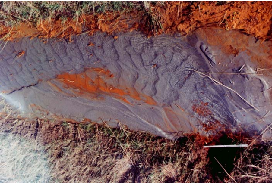
Foto b5.3 Zandmeevoerende wel in slootkant Waalbandijk Noord, na een hoge buitenwaterstand. [RWS-DWW 132/4a]
