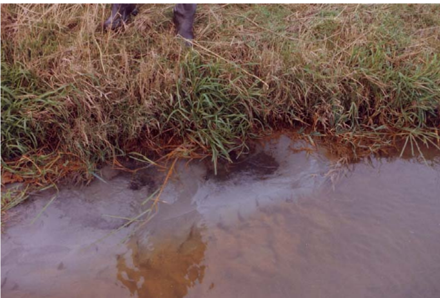
Foto b5.4 Verkleuring van het slootwater door zandmeevoerende wel in kwelsloot nabij Waardenburg. [RWS-DWW 125/16]
