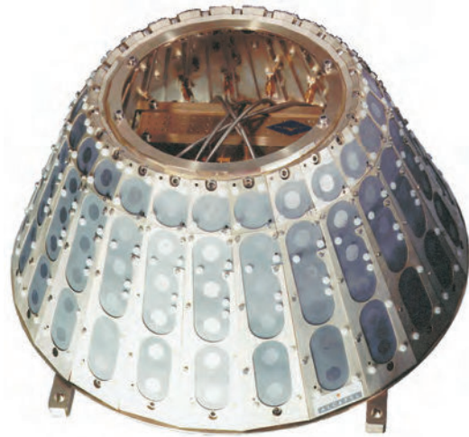
Figuur 1: Conformal array antenne voor LEO platformen (ALCATEL SPACE)
