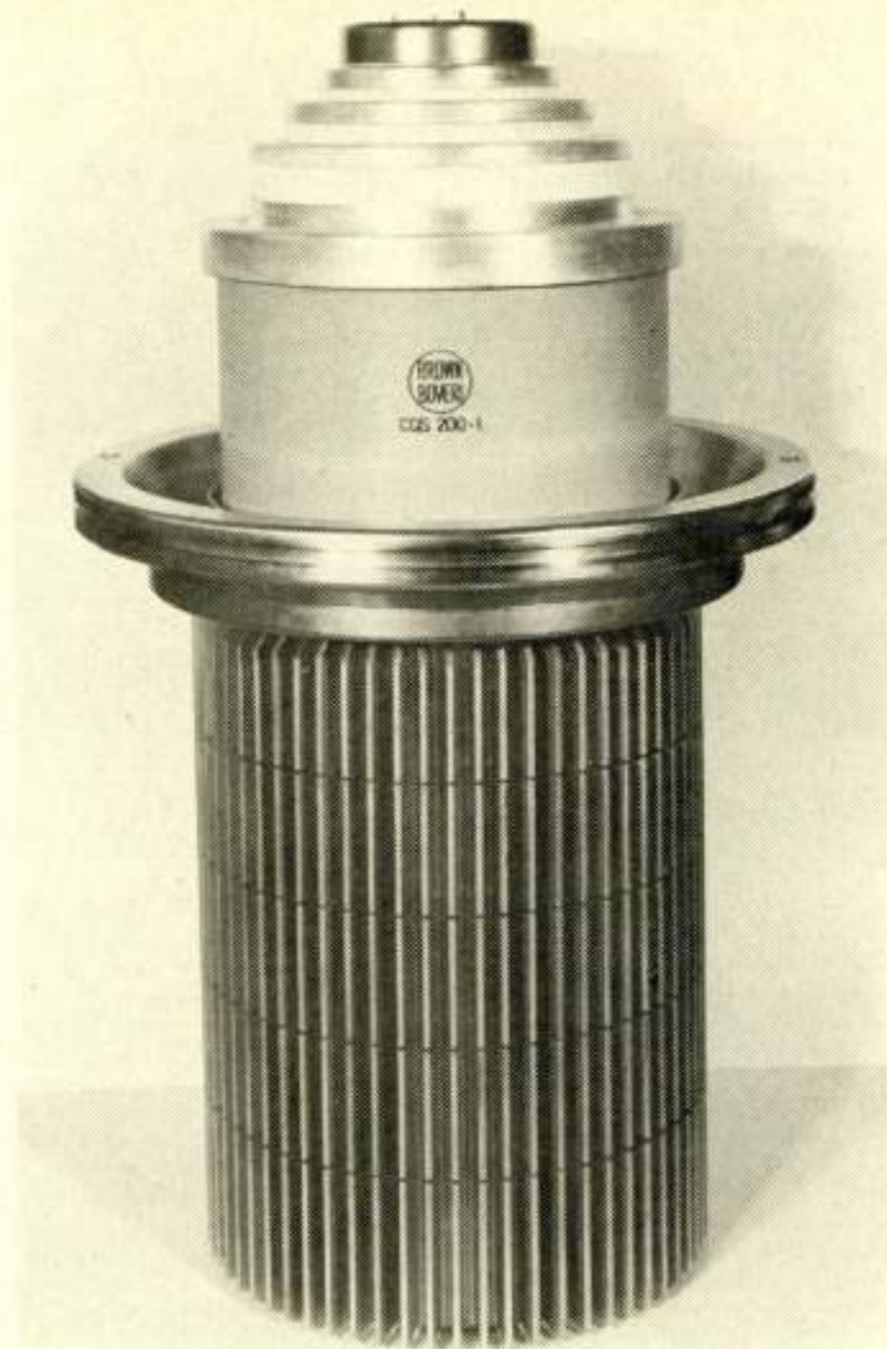
Fig. 1. Zendertetrode type CQS 200-1, met verdampingskoeling. Maximale waarde voor de anodedissipatie 200 kW, voor de anodespanning 22 kV en voor het uitgangsvermogen 500 kW. Hoogste werkfrequentie 30 MHz.
