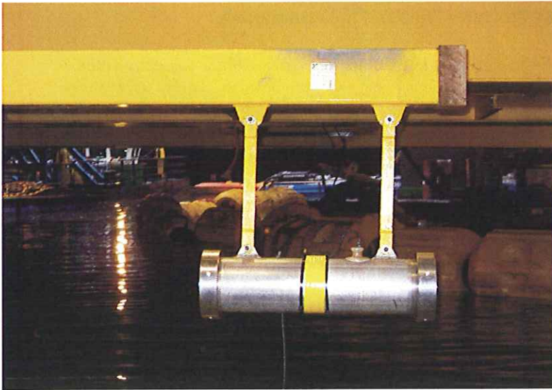
Foto 4 :Eerste inzet van de IR-camera (eerste prototype) onder bovenloopkraan in bouwkuip van Amsterdam Centraal Station
