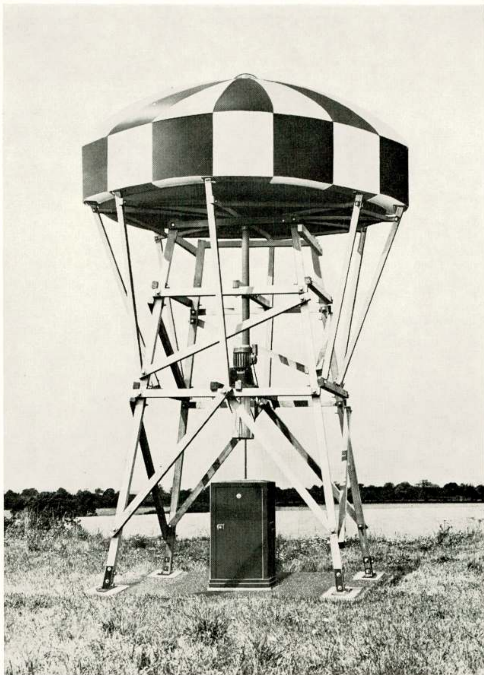
Figuur 1. Antenne en ontvanginstallatie van de Standard Doppler peiler DDF. 1. Twee VHF verticale dipoolantennes, onderlinge afstand \pm 3,60 m, roteren met 3 omw/sec. in een koepel van fiberglas met kunsthars versterkt. In de gietijzeren kast is de VHF radio-ontvanger ondergebracht. De antenne-installatie is ca. 6,50 m hoog bij een \varnothing van ca. 5 m. In de verkeerstoren bevindt zich meestal de indicator met stuureenheid.
