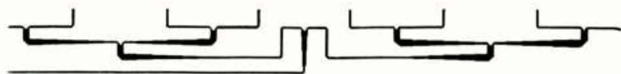
Figuur 3: Deel van stripline corporate feed. Er zijn 2x3 van zulke structuren.
