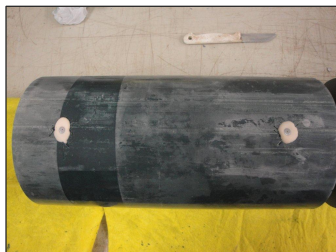
Foto: Opstelling meting uittreksterkte
