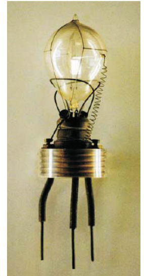
Fig.1 De vacuümdiode [5] zoals door Fleming in 1904 ontwikkeld
