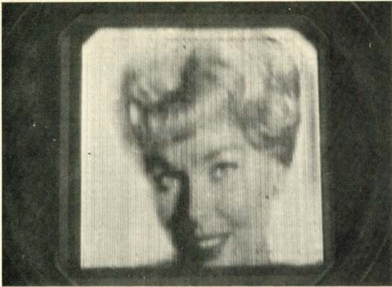
Fig. 12. Experimenteel TV-paneel bestaande uit een matrix van 10 000 glimlichtjes. De definitie van het paneel is 100 \times 100 lijnen.
