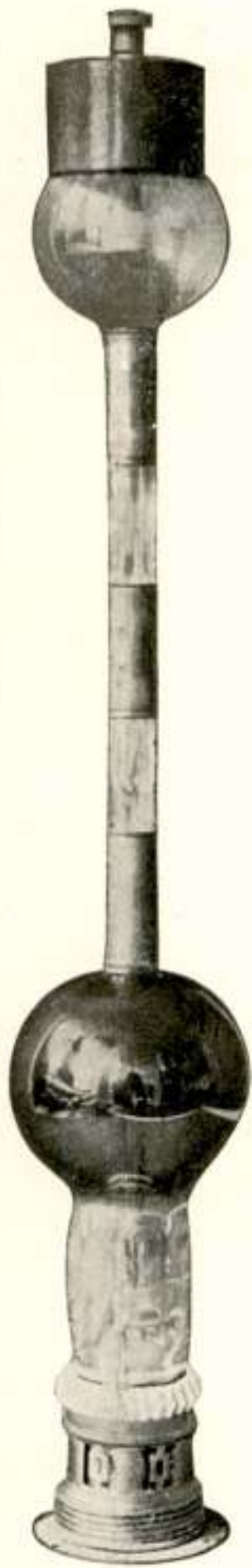
Figuur 3. Gelijkrichterbus voor 100 kV — 1,5 A.
