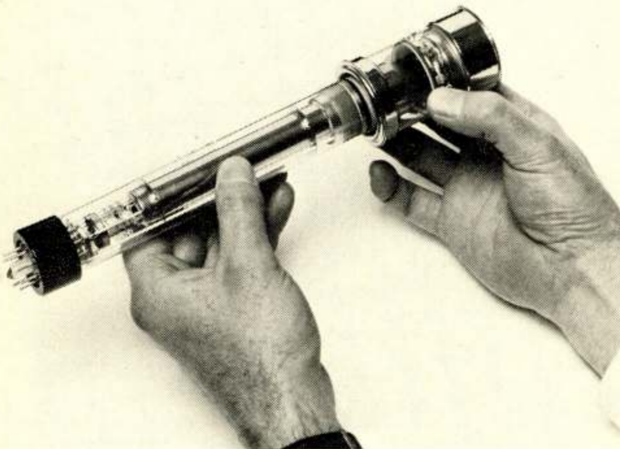
Fig. 12. Koppeling van een Plumbicon met vezeloptiekvenster (links) met een lichtversterker (rechts).
