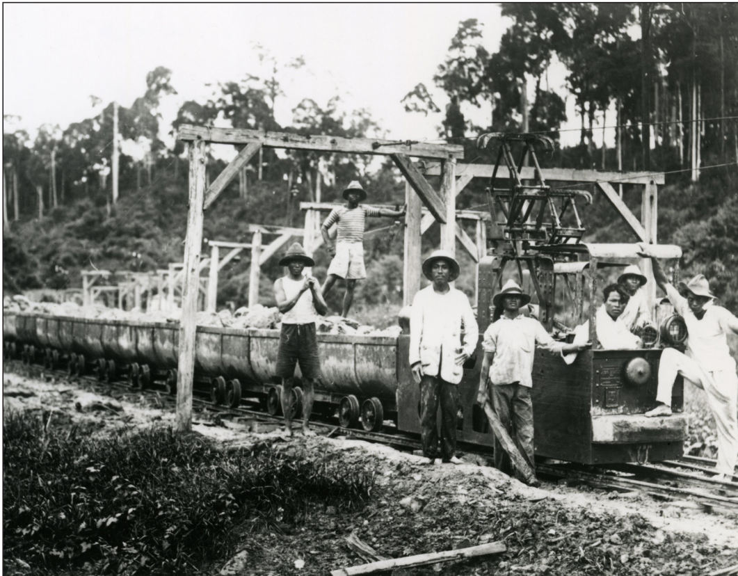
De Steenkolen Maatschappij Parapattan was een zeer efficiënt bedrijf, dat alleen aan het moederbedrijf, de Koninklijke Paketvaart Maatschappij, kolen leverde. Elektrische locomotieven van AEG vormden de tractie op de mijn.
