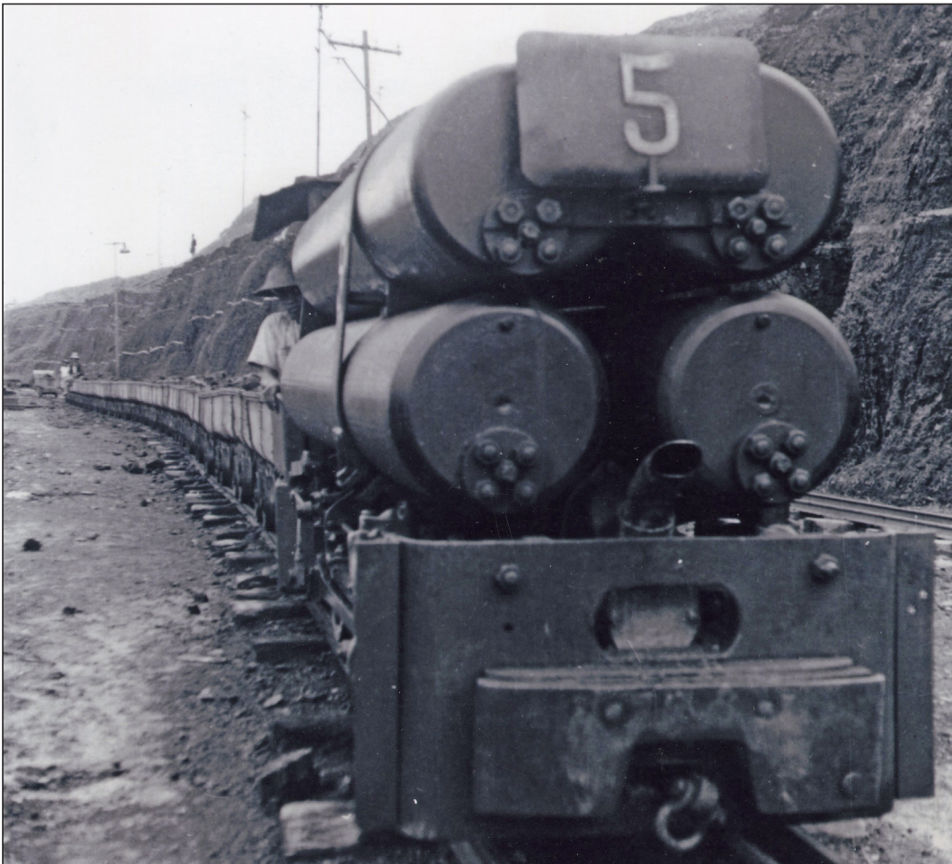
In de Limburgse steenkolenmijnen reden honderden persluchtlocomotieven, bij het Gouvernements-bedrijf der Boekit Asam Steenkolenmijnen op Zuid-Sumatra reden negen door Schwartzkopff gebouwde lichtlocomotieven. Op de foto locomotief 5 met mijnwagens te Tandoeng Enim, 1948.
