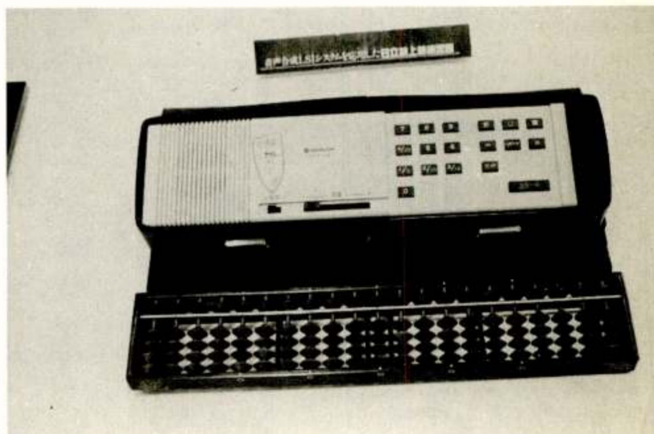
Fig. 3 Elektronische abakus van Hitachi
