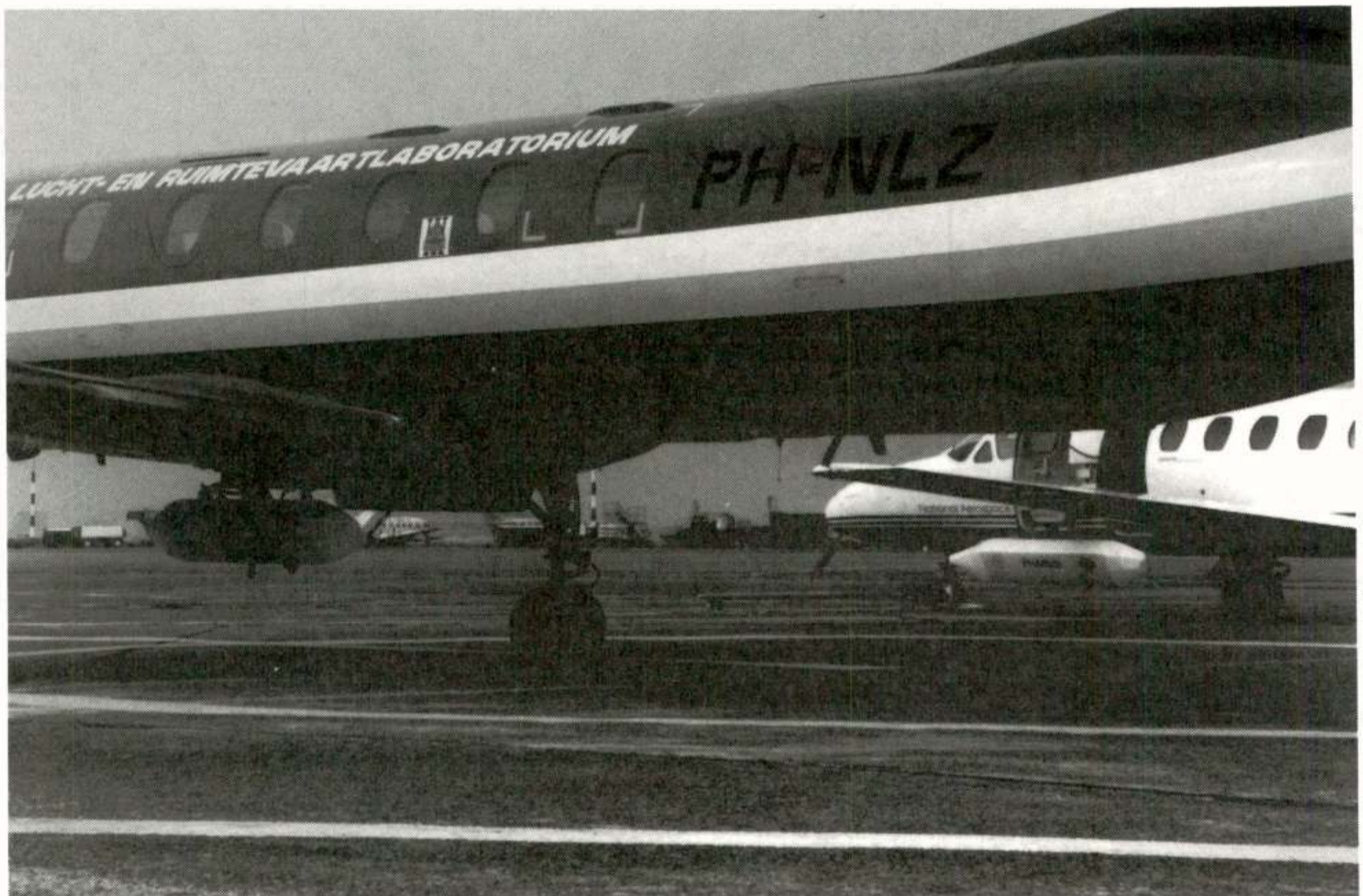
figuur 11: Op voorgrond het testbed aan de Metro II en op de achtergrond de PHARUS mock-up aan de Citation.
