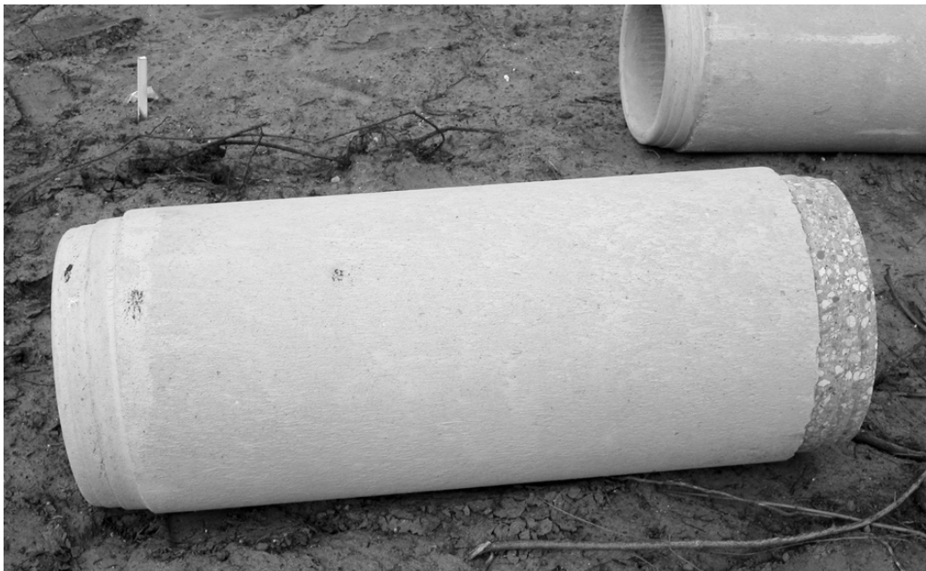
Figuur 6.5 Op fabriek gemaakte pasbuis met glijverbinding, spie-einde rechts gefreesd op de fabriek
