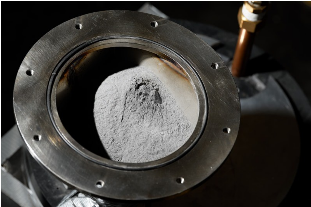
De trechter in de nieuwe ijzerverbrandingsinstallatie van Team SOLID, met het ijzerpoeder dat verbrand gaat worden.
