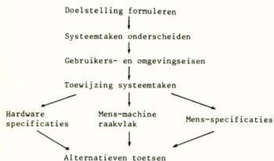
Figuur 2. Fasen bij het ontwerpen van mens-machine systemen
