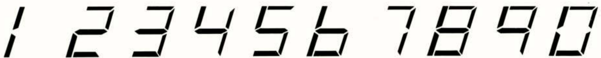
Fig. 2: Voorstel voor verbeterde zeven-segment cijferconfiguraties.
