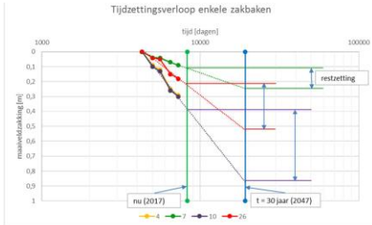
Figuur 3: zettingsgedrag enkele zakbaken
