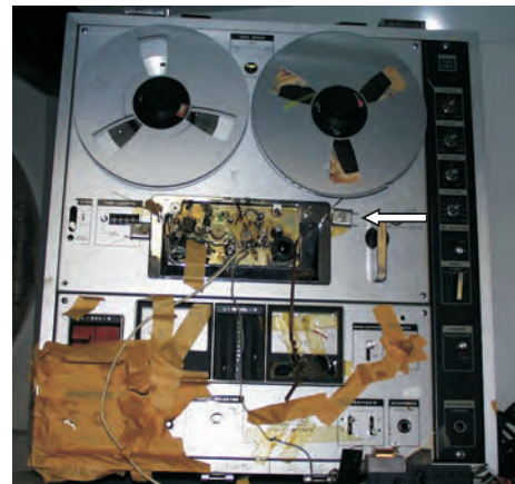
Gemodificeerde bandrecorder voor langdurige uitzending.
