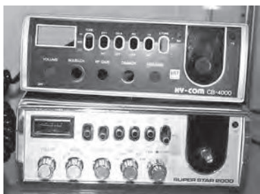
Illegale 27 Mc set met "legaal" voorzetfront voorzien van certificaat.
