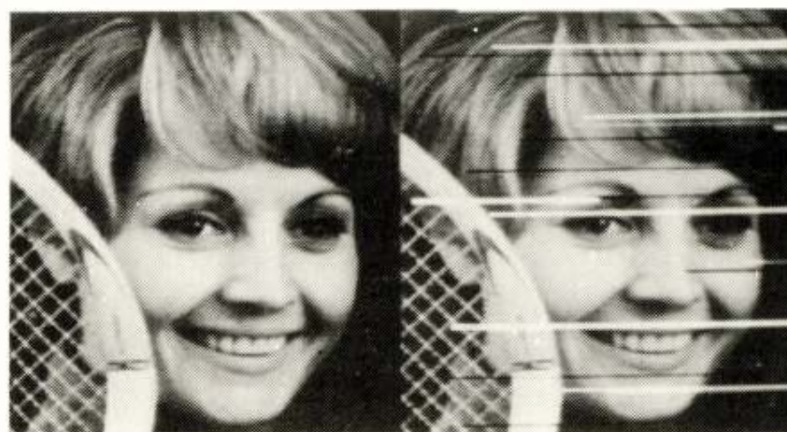
Fig. 6 4-bit DPCM prediction : b=A quantizer : non-linear error rate : 4 \times 10^{-3} .
