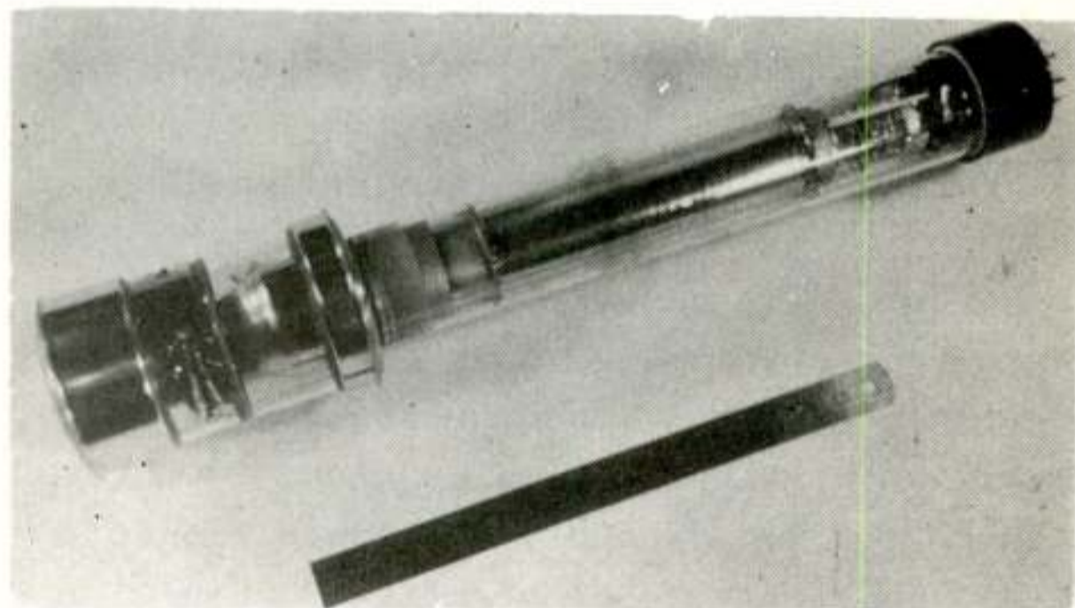
Fig.2. Plumbicon camerabuis en helderheidsversterker.
