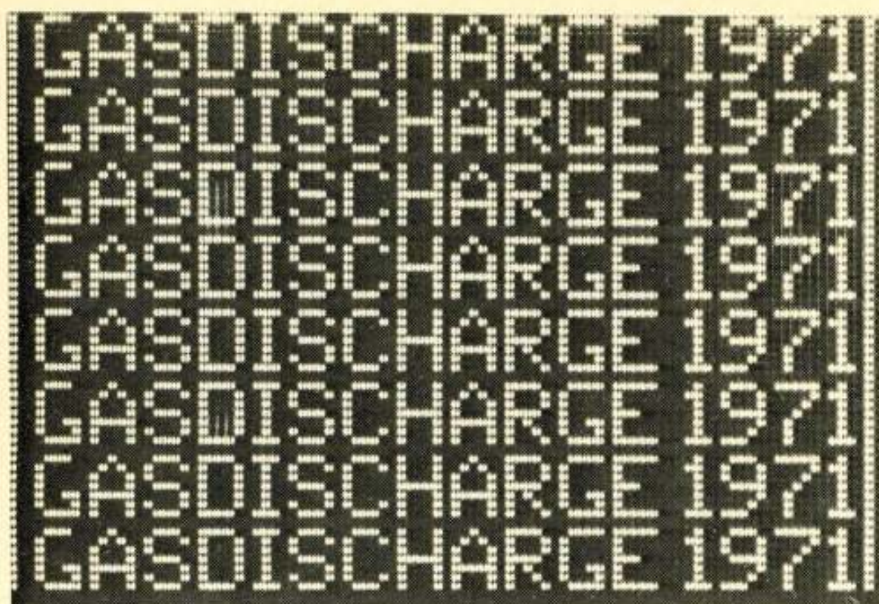
Fig. 6. Experimenteel 12 x 16-karakter alfanumeriek data-paneel.
