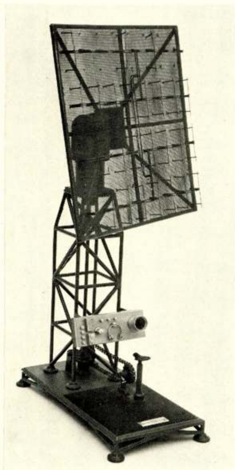
Fig. 1. Schaalmodel van de eerste Nederlandse radar.
