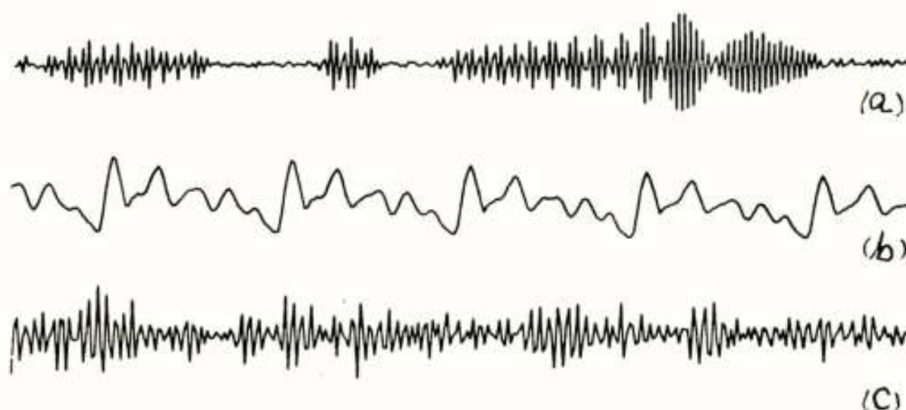
Fig. 3. Spraak in beeld. Een lang segment (a), en 2 detailopnamen: stemhebbend (b) en stemloos (c).
