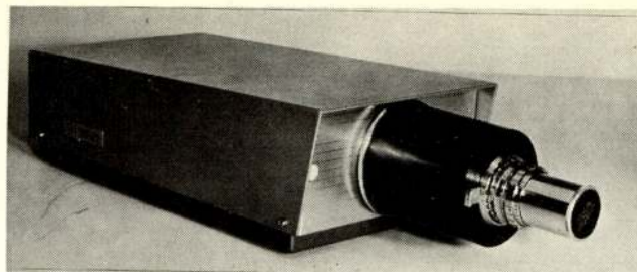
Fig. 17. TV-camera, voorzien van een Plumbicon camerabuis met vezeloptiek-ingangsvenster, gekoppeld met een helderheidsversterker met vezeloptiek-ingangs- en uitgangsvensters.
