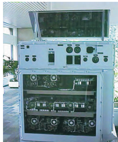
Elektromechanisch vuurleidingstoestel ("rekenaar") Fabrikaat N.V. Hollandse Signaalapparaten, 1952-1960
