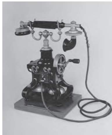
Ericsson tafel-telefoonstoel ca. 1905. Een handinductor zorgt voor het weksignaal (foto: Joosen en Schongs)
