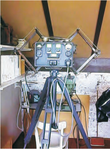
SIG. 500 MHz straalverbinding-zendontvanger. Het schijnt dat onder ideale omstandigheden een bereik van meer dan 100 km realiseerbaar is.
