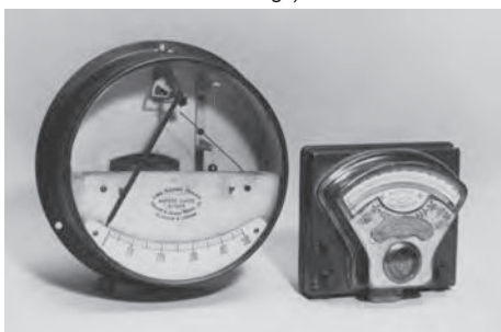
Ampèremeter van omstreeks 1900. Zwaartekracht zorgt voor het terugstelmoment. (foto: Joosen en Schongs)
