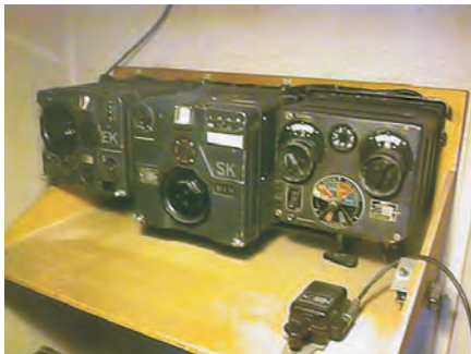
FuG10 (Funk Gerät 10). In deze uitvoering: 3 MHz –6 MHz. Rechts afstandsbediening voor antenne-aanpassing eenheid.
