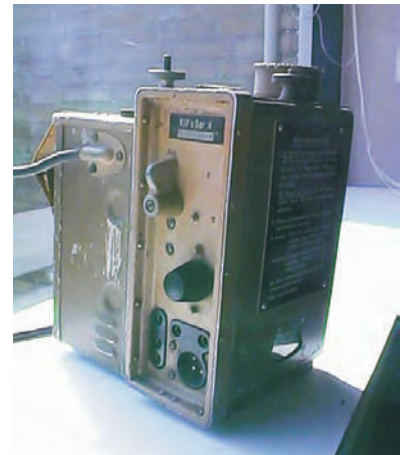
KIFuSpr d (Klein Funk Sprecher Dorette), Duitse tegenhanger (ontworpen door Philips) van de Amerikaanse handy talky. Links de batterijkast. Slechts een telefoon / microfoon en antenne hoeven aangesloten te worden voor gebruik.
