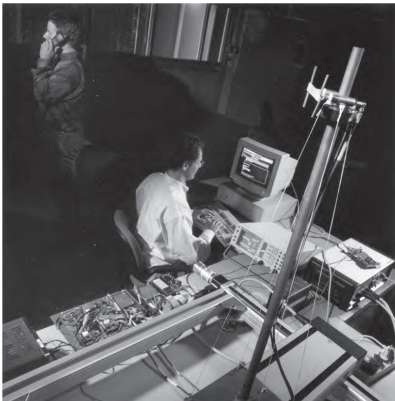
Figuur 3: De meetopstelling in gebruik, een prototype van een diversity ontvanger wordt geevalueerd.
