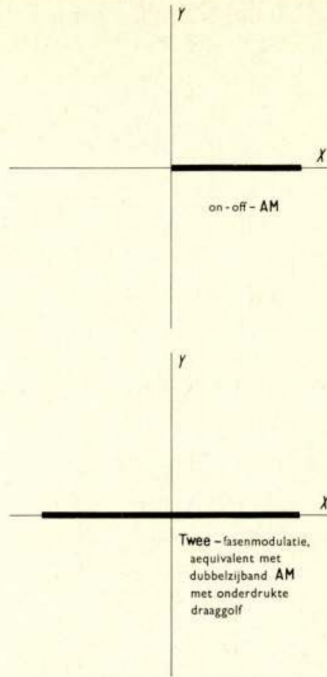
Fig. 8. Vectordiagrammen van een 'on-off'-systeem en een tweefasensysteem volgens par. 4.1.; (f_2 - f_1) impulsen/s.
