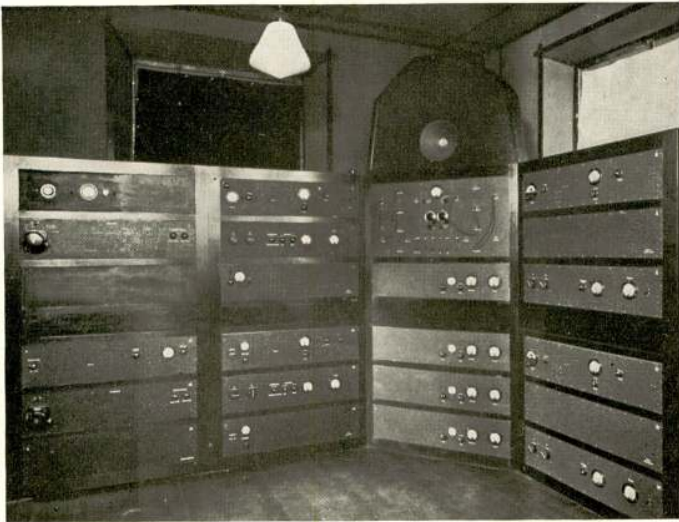
Radio-Kootwijk. Tweede voorzetapparaten en verdeelpaneel voor de zenders.
