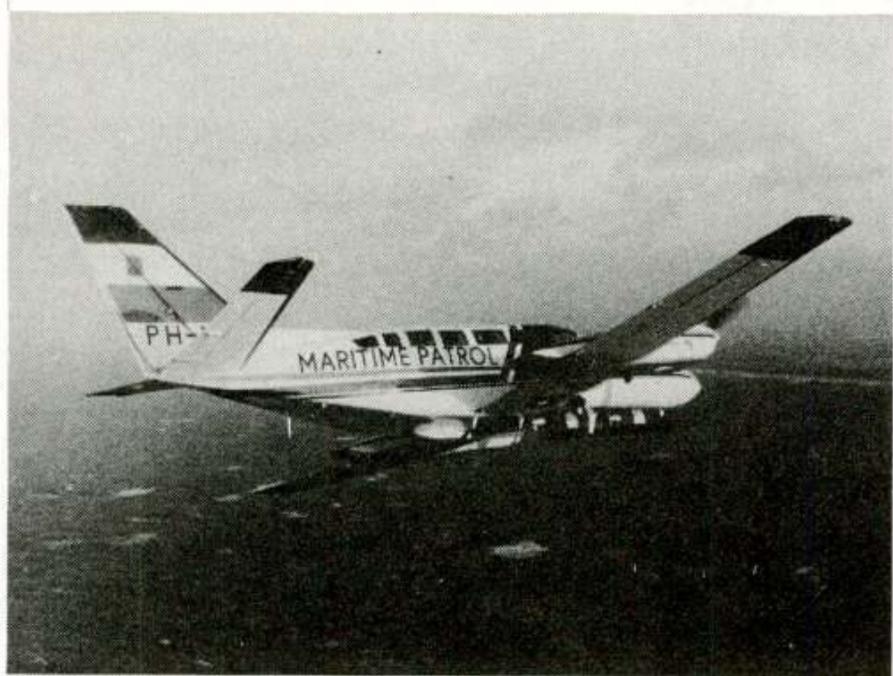
Fig. 2: Het oliedetectievliegtuig van Verkeer en Waterstaat. De "lange pijp" onder de neus is de SLAR-antenne.
