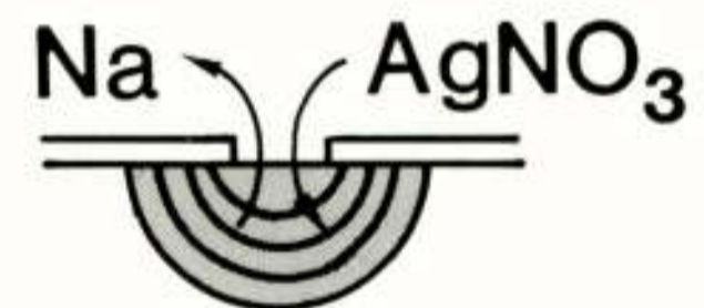
Figuur 7: Lichtgeleiders gemaakt met ionenuitwisseling. Door concentratieverschillen worden natrium en zilverionen tegen elkaar uitgewisseld op de open plaatsen in het masker.
