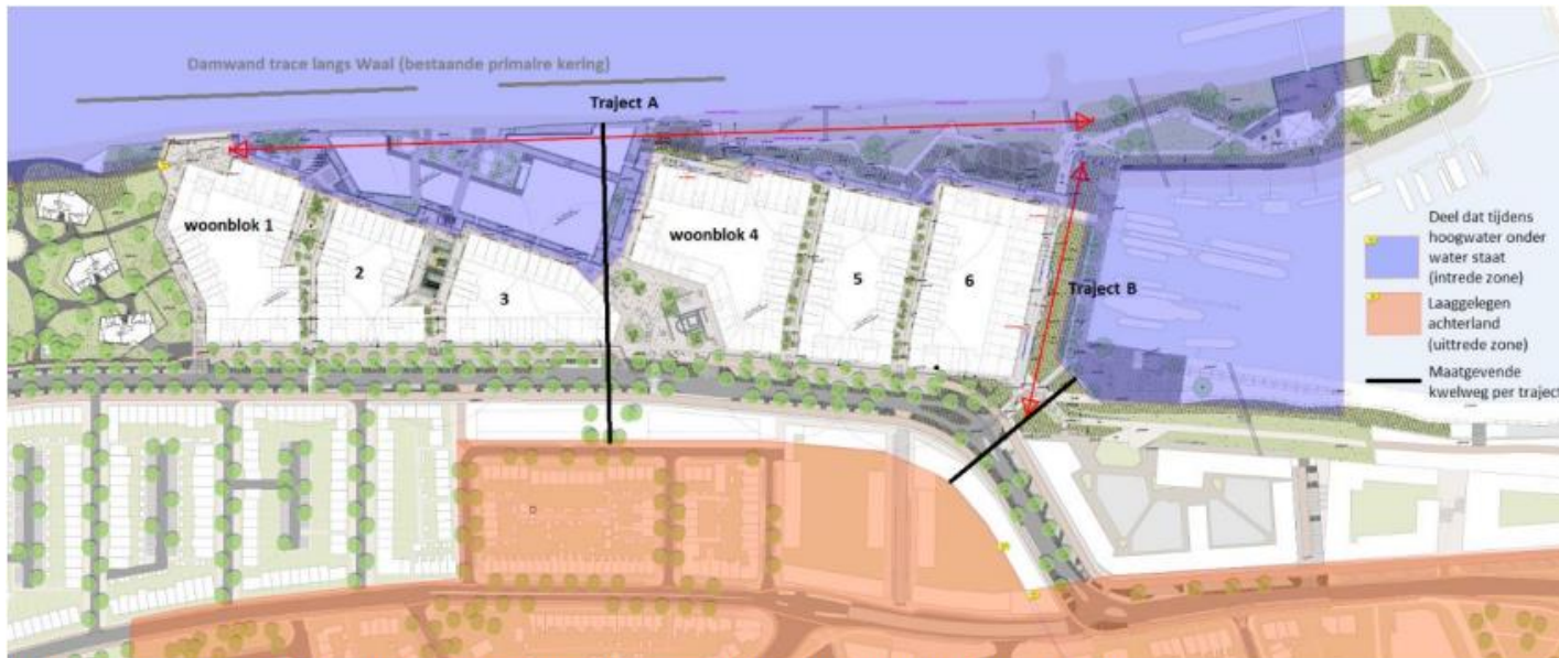
Figuur 1 Deeltrajecten piping-analyse Waalkwartier en maatgevende kwelwegen per deeltraject
