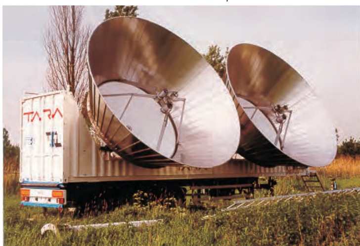
Fig. 11: De TARA radar met gekantelde antennes. De schermen aan de rand van beide parabolen springen in het oog. Te zien is dat in elk der antennes een draagstructuur met drie belichters is gemonteerd. Het bedieningscompartiment is verscholen achter de rechter parabool.
