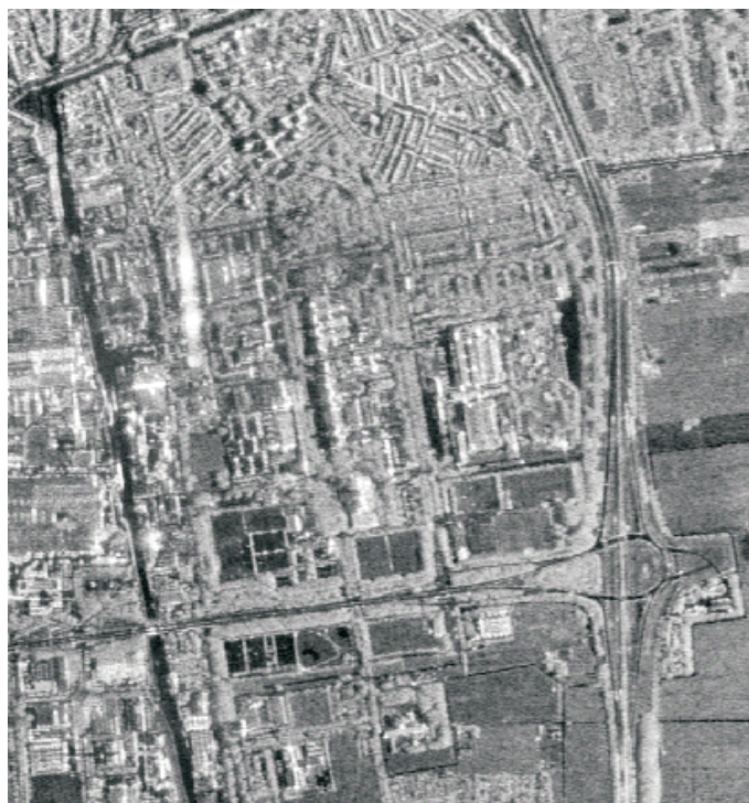
Fig. 1: PHARUS ( Phased Array Universal SAR ) radarbeeld van de TUD wijk, opgenomen vanaf 10 km afstand, op een hoogte van 4 km, met een resolutie van 4 meter. PHARUS is een experimentele phased array vliegtuig Synthetische Apertuur Radar, werkend op C-band (5.3 GHz).
