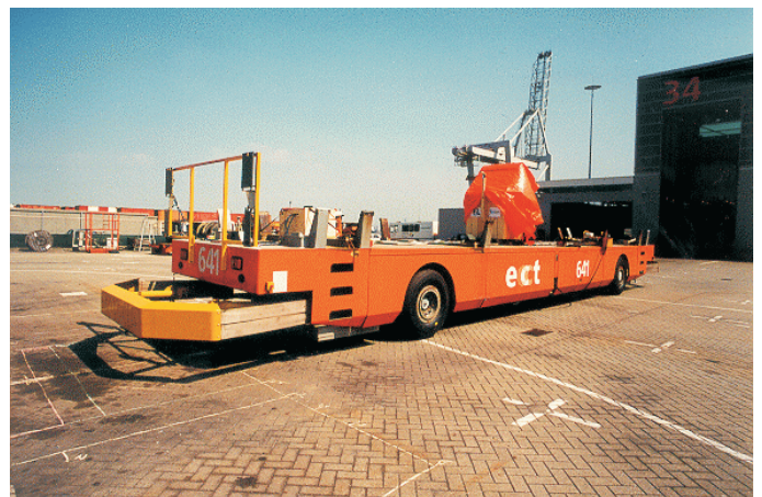
Fig. 2: De antibotsingsradar COLARADO staat op de voorkant van een transportvoertuig. De geminiaturiseerde radarantennes zijn gemonteerd in het gespijlde frame.
