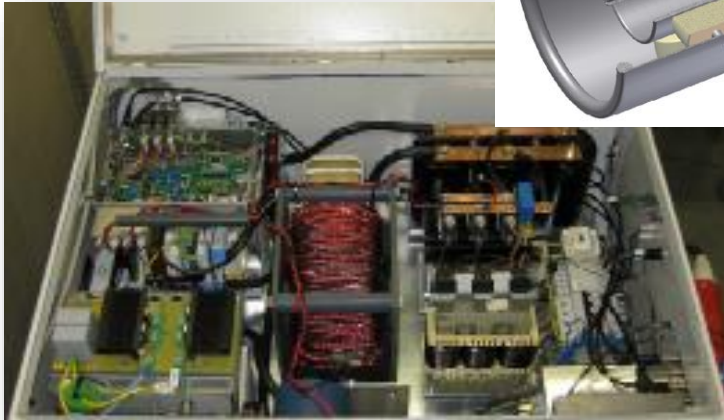
Smart charger, 30 kV, 5 kHz, 20 kW, 30 \mu s, 96 % efficient
