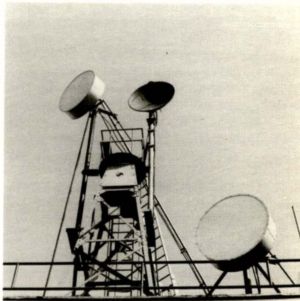
Foto 1: Antennes (links boven en rechts onder) van de PTT-PTI veldproef op 18 GHz. In 't midden een 13 GHz antenne.
