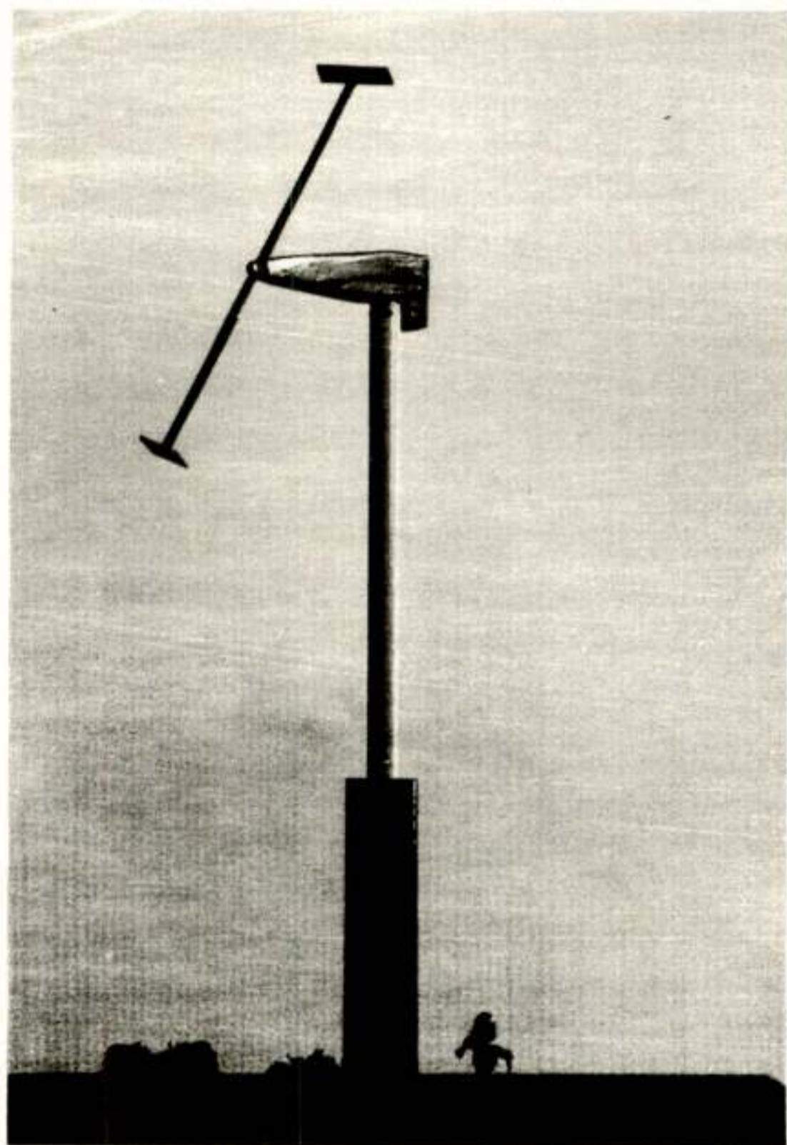
Fig. 3: Experimentele windmolen met tipvanes
