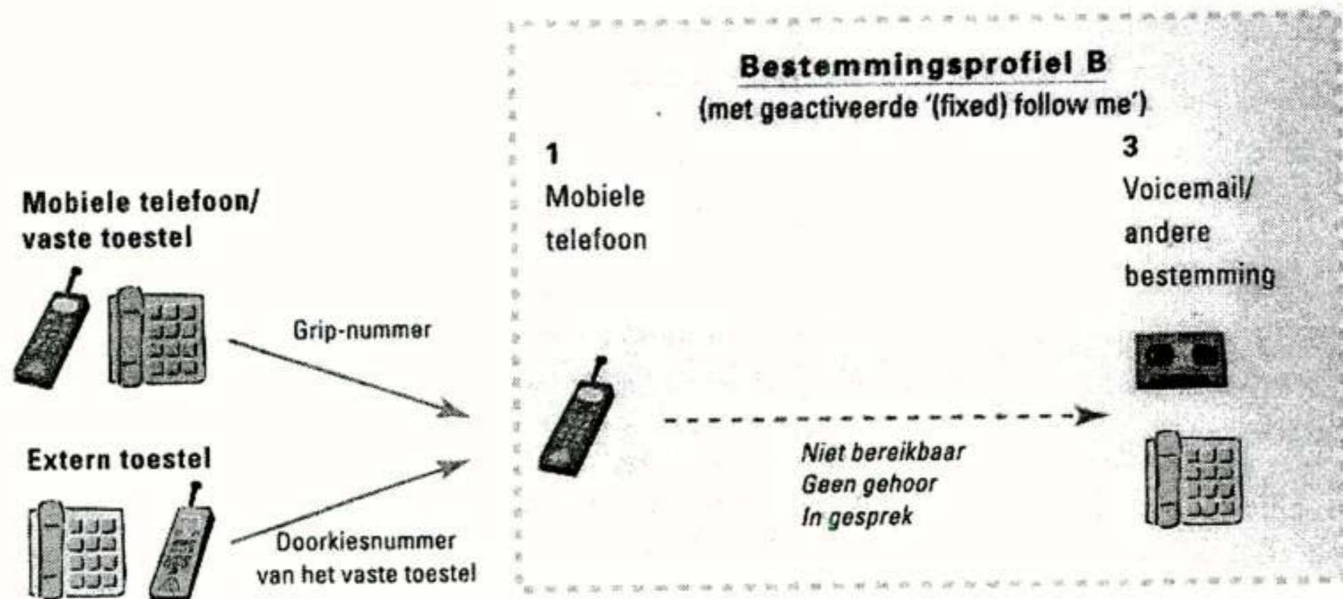
Figuur 3. Afhandeling van een oproep naar een Grip-gebruiker met bestemmingsprofiel B met geactiveerde 'follow me' naar Grip
