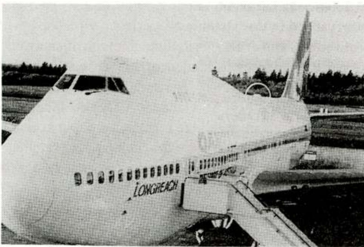
Figuur 7. Inmarsat is niet alleen sterk ter zee, maar manifesteert zich ook te land en in de lucht. Met een cirkel is aangegeven waar zich op het vliegtuig de satellietantenne bevindt, waarmee spraak-, data- en faxverkeer voor passagiers, alsmede vluchtinformatie kan worden uitgewisseld.
