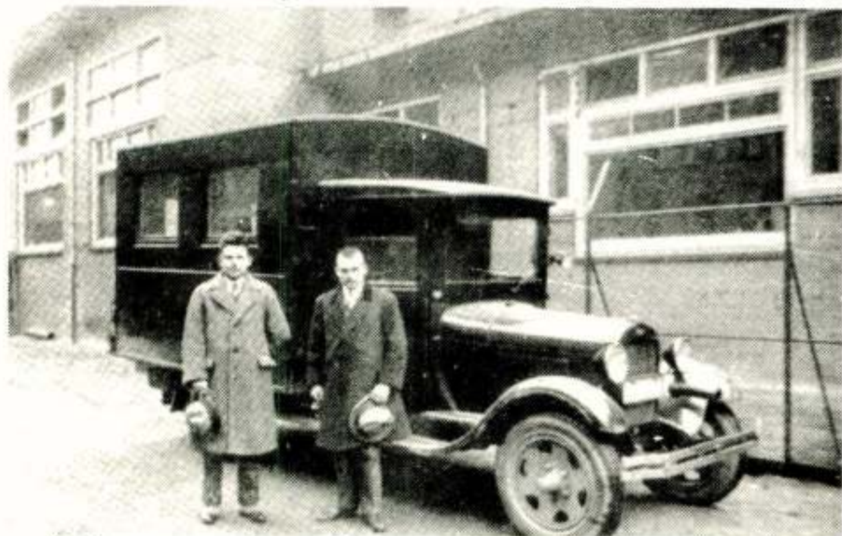
Meetwagen en bemanning gereed voor veldsterktemetingen (uit het artikel van Dr. B v.d. Pol, deel 4 van ons Tijdschrift).
