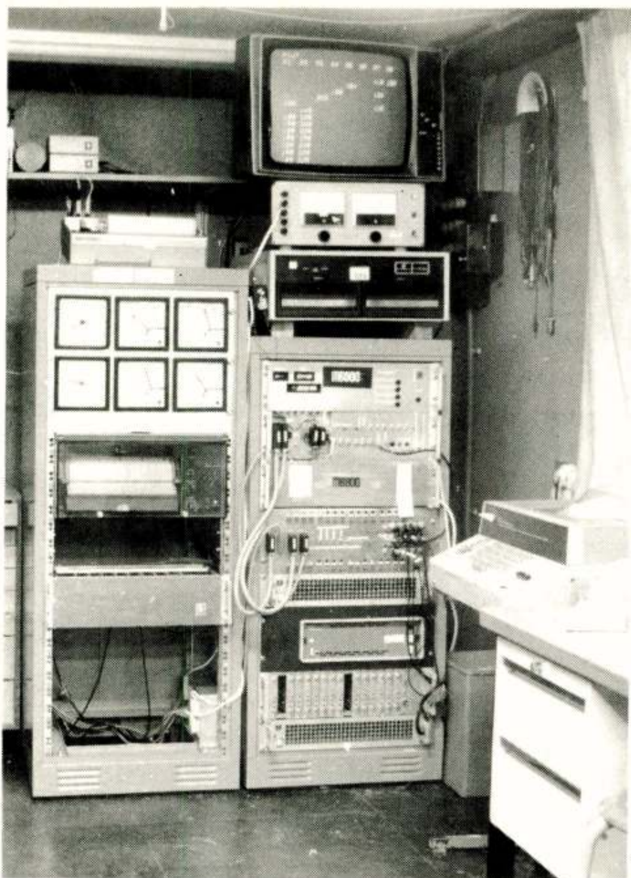
Fig. 3 : Het data-acquisitie systeem. Visuele controle van de meetgegevens is mogelijk op een video display.
