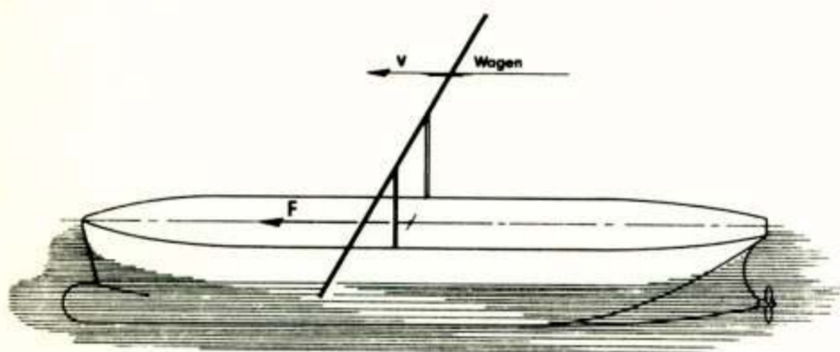
Fig. 3. Kracht- en momentmeting voor het bepalen van het vermogen en het rendement van de voortstuwcr, met en zonder inwerking van de scheepsvorm.
