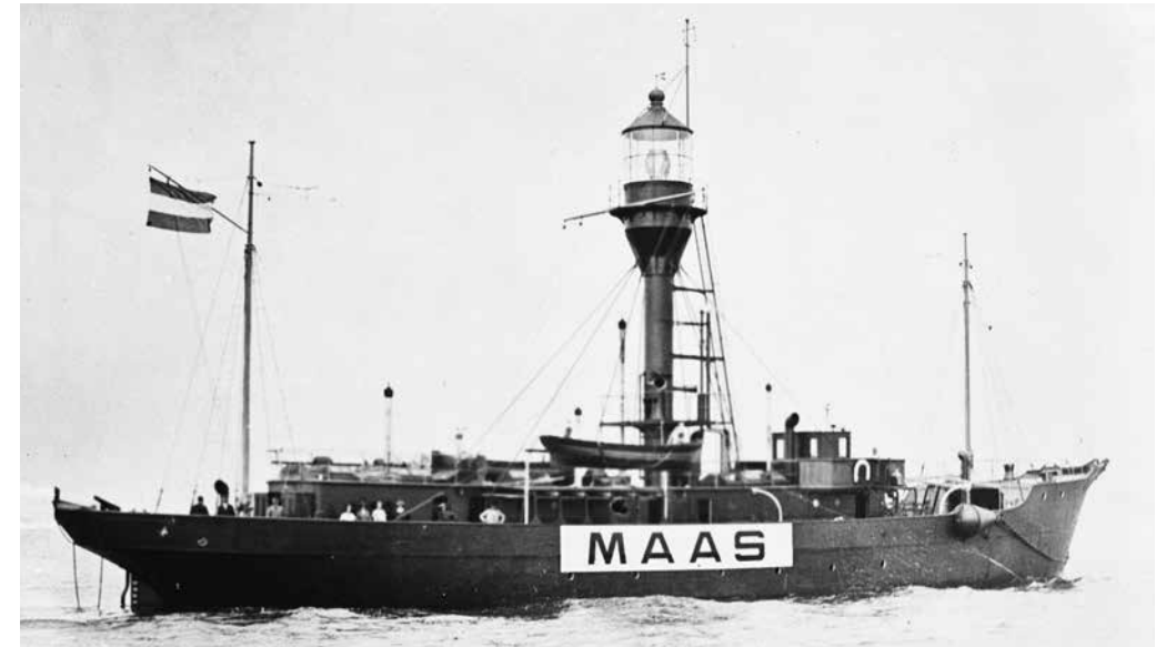
In 1902 werd in Nederland de eerste radioverbinding tot stand gebracht tussen Hoek van Holland en het lichtschip 'Maas' dat circa 15 meter uit de kust lag. Lichtschepen werden als een soort vuurtorens op het water neergelegd op plaatsen waar de scheepvaart gewaarschuwd moest worden.
