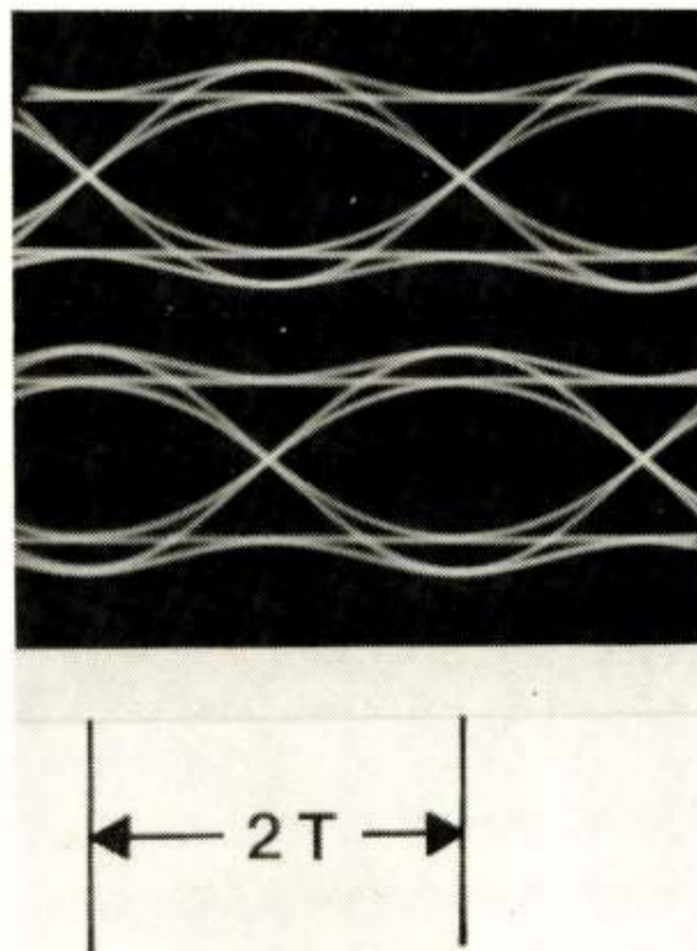
Fig. 12. "Eye-patterns" van \sin(\varphi(t)) en \cos(\varphi(t)) in de zender in Fig. 11.
