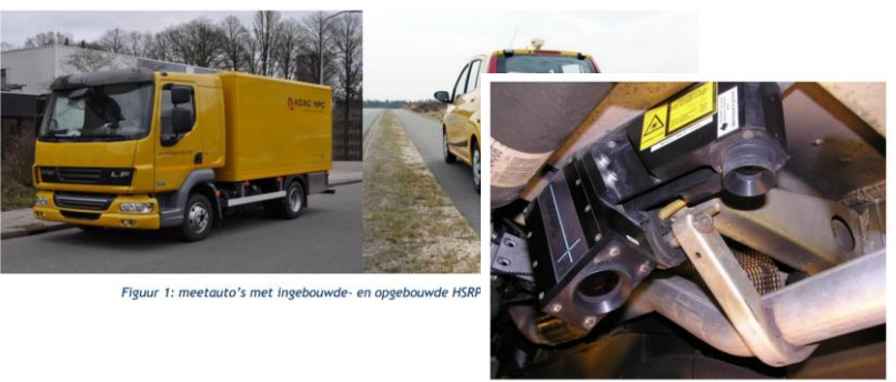
Figuur 2: HSRP-meetsysteem onder meetauto
