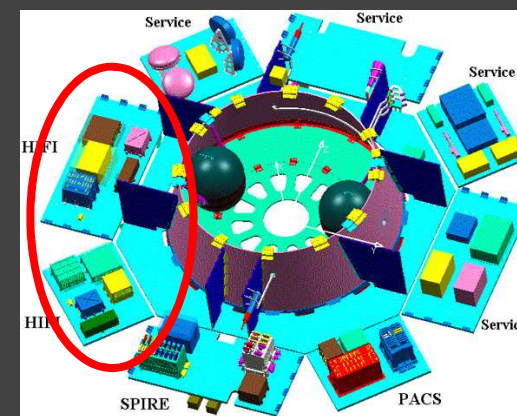
FPU in brandvlak in cryostaat
