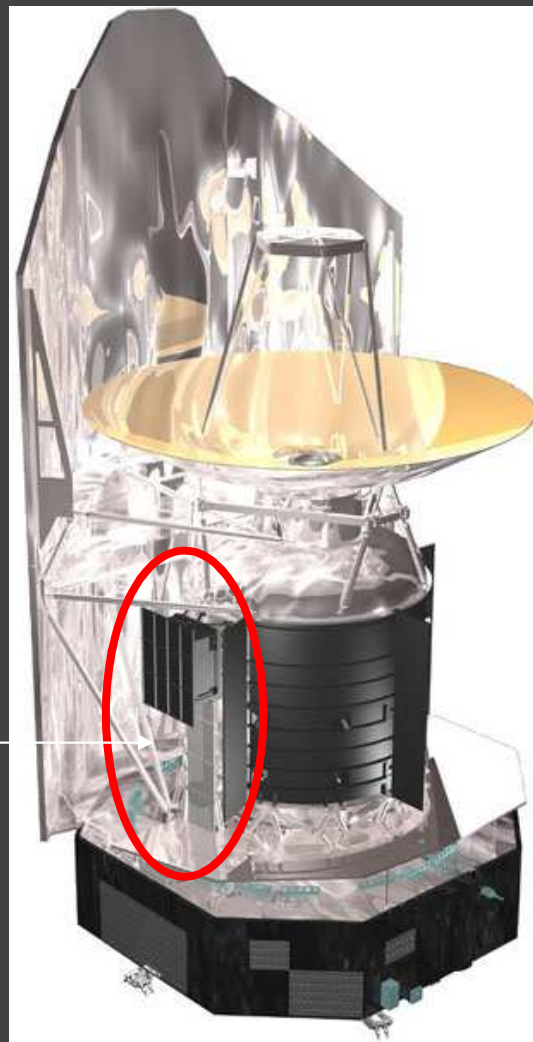
FPU in brandvlak in cryostaat
