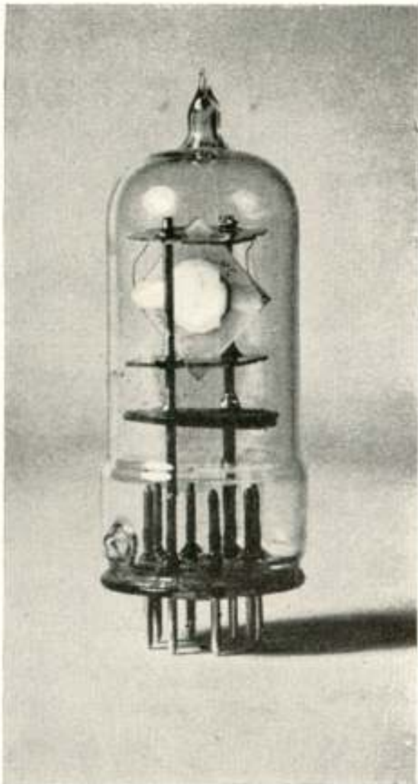
Foto d. BT -snede met ondersteuningsdraden, gesoldeerd aan de hoekpunten; frequentie gebied ongeveer van 2,5 tot 10 M Hz.
