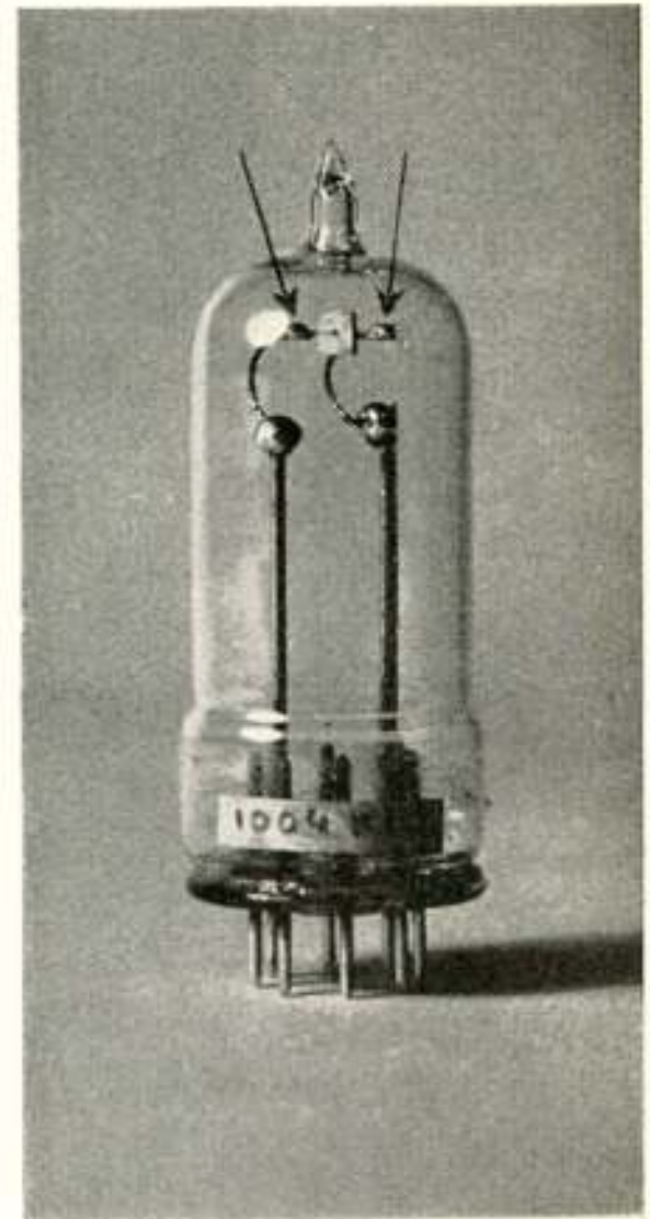
Foto e. CT -snede van ongeveer 1000 kHz, waarbij, teneinde de verliezen te verminderen, de aangesoldeerde ondersteuningsdraden afgestemd zijn door middel van soldeerballletjes.
